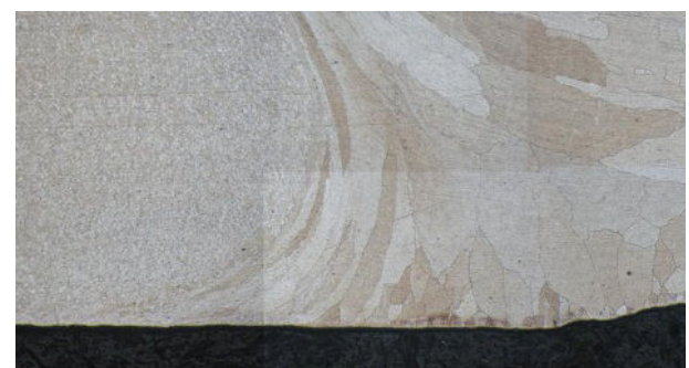
Figura 5. Transición entre la ZA y ZTMA en el lado de avance, condición Vs-Vr: 125-1250.
