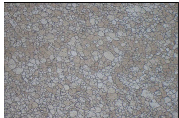
Figura 4. Microestructura de la zona agitada, condición Vs-Vr: 125-1000 a 200X.
