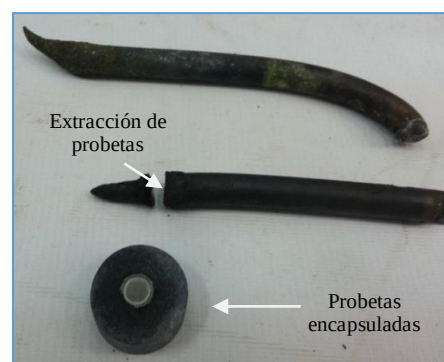
Figura 1. Obtención de probetas para análisis microestructural y espectroscopía Raman.
