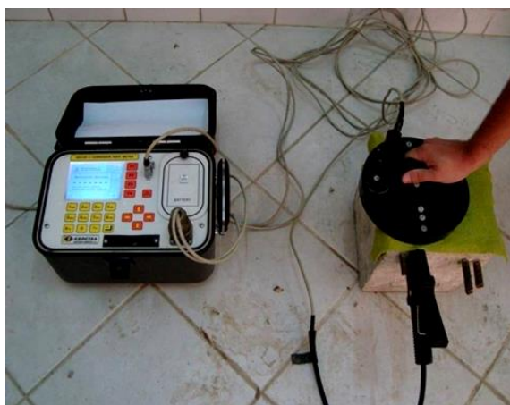
Figura 4. Sistema de medición empleado en las mediciones de intensidad de corrosión.
